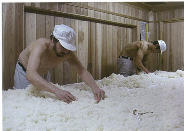
蒸米に麹菌を混ぜ合わせ、全体的に手でほぐす。素材の状態、気候などを考えながら、発酵の進み具合を微妙に調節する。
